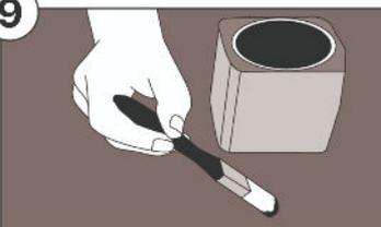
Appliquer la colle au pinceau en suivant les consignes indiquées par le fabricant de colle. Généralement, la colle vinylique nécessite un encollage d'une des surfaces, alors que la néoprène nécessite un encollage des deux surfaces.
