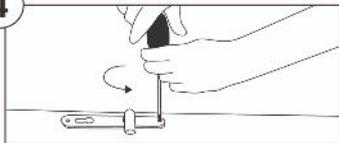
Déposer la garniture de votre porte à l'aide d'un tournevis adapté à l'empreinte des vis.
