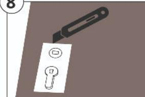
Repérer l'emplacement de la garniture de la porte et ses dimensions pour découper le placage et remonter la garniture dans l'obturation une fois le placage collé.
