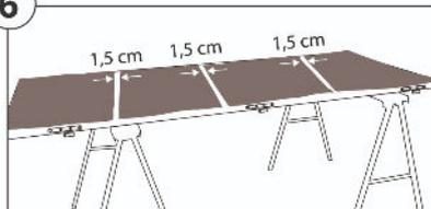
Positionner les 4 panneaux de placage du kit à leur emplacement prévu et en laissant 1,5cm d'espace entre chaque pour le placement des profils alu.
