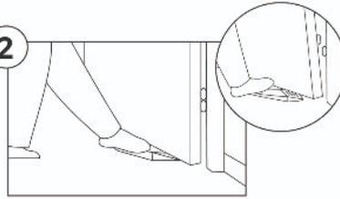
Dégonder la porte idéalement à l'aide d'une cale adaptée à cet usage.
